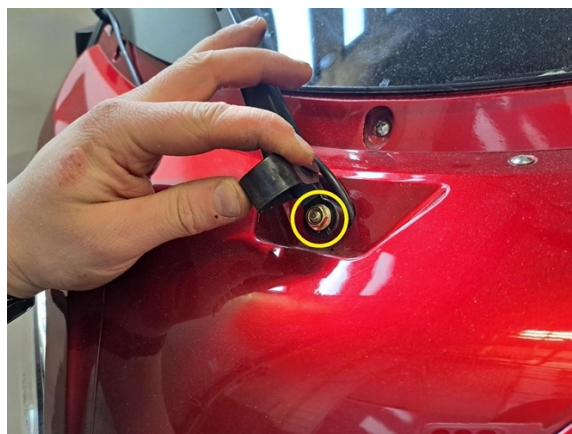
Irrota tuulilasinpyyhkijän kiinnitysmutteri. (kiintoavain 10 mm).
