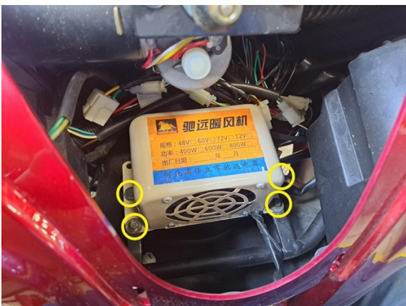
Irrota lämmityslaitteen kiinnityspultit, (hylsy 8 mm) joilla vastamutterit. (kiintoavain 10 mm).
